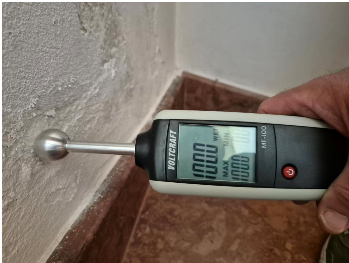
5. kép: Voltcraft MF-100 mérőműszer alkalmazása az Esterházy Kiskastély alagsorában
