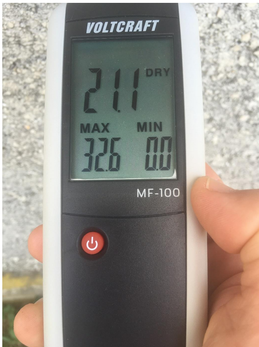
6. kép: A Deák Ferenc utcai raktárbázis külső falainak nedvességtartalom-mérése Voltcraft MF-100 műszer alkalmazásával.
