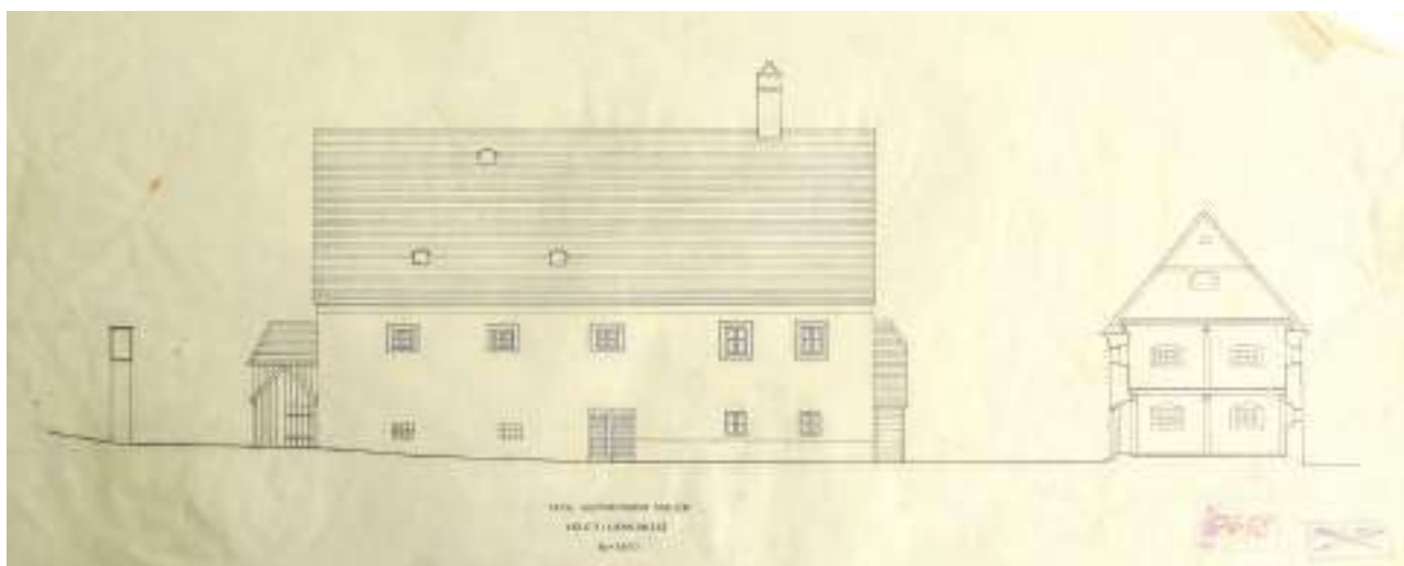
3. kép: A Nepomucenus-malom épületegyüttesének felmérési rajza kelet felől nézve, a magtárépület metszetrajzával, 1951. (MÉM MDK Tervtár, rajzi gyűjtemény, 7658. sz.)
