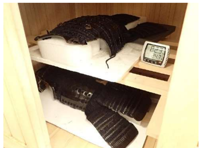
A testpáncél két része a javító lakk térhálósodását elősegítő pára kamrában
