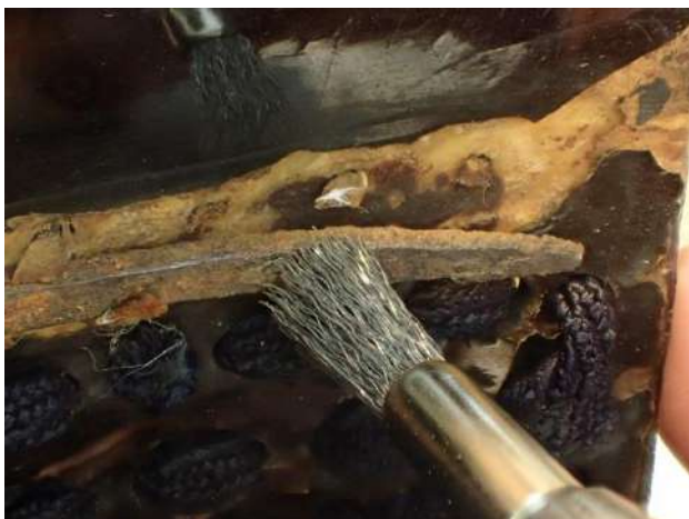
A merevítő vashuzal tisztítás közben
