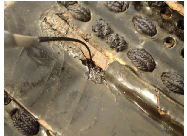
A stabilizáló lakk keverék bejuttatása mikro pipettás módszerrel.
