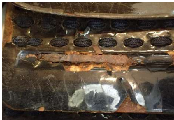
Korrodálódott vashuzal az egyik szoknyalemez hátoldalán
